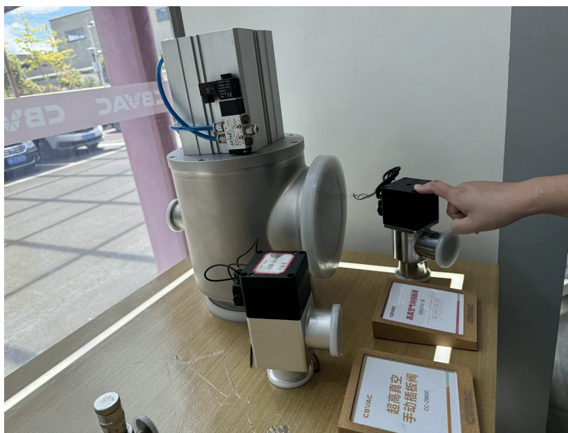
Демонстрационные исполнения высоковакуумных клапанов CBVAC с электромагнитным и пневматическим приводом
